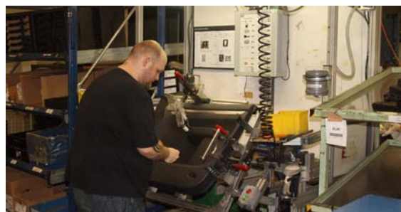
Montage einer Türverkleidung bei Röchling Automotive in Wolfsburg
